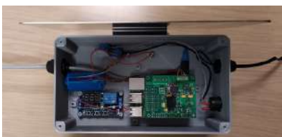
WT-WT01: Unità centrale, comprensiva di: (1) Mini-PC; (2) Relé Temporizzato; (3) Regolatore di tensione; (4) Shield Vuoto; (5) Scheda di Memoria Estraibile; (6) Pulsante ON/OFF.
